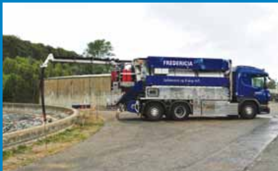
Vores egen slamsuger bruges primært til vedligeholdelse af pumpestationer, men kan også udføre andre spuleopgaver.
